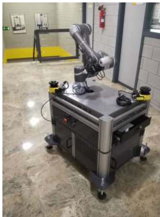
Robot colaborativo OMRON sobre el carro de transporte con los sensores láser instalados
