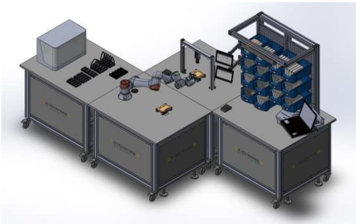
Vista en perspectiva de la Línea 2 de la PFI
