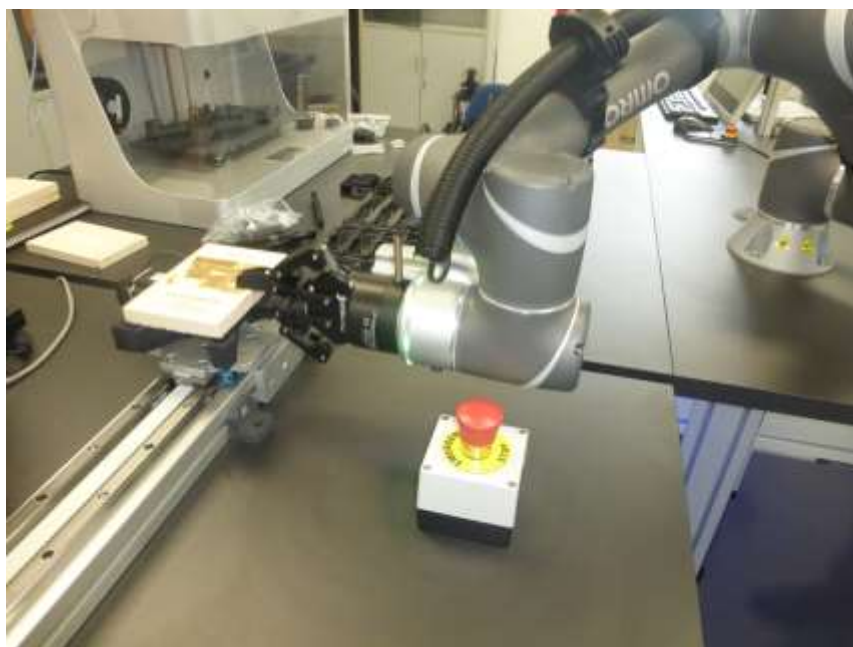
Figura 6- Recogida de tablilla por el cobot de montaje al finalizar proceso de mecanizado
