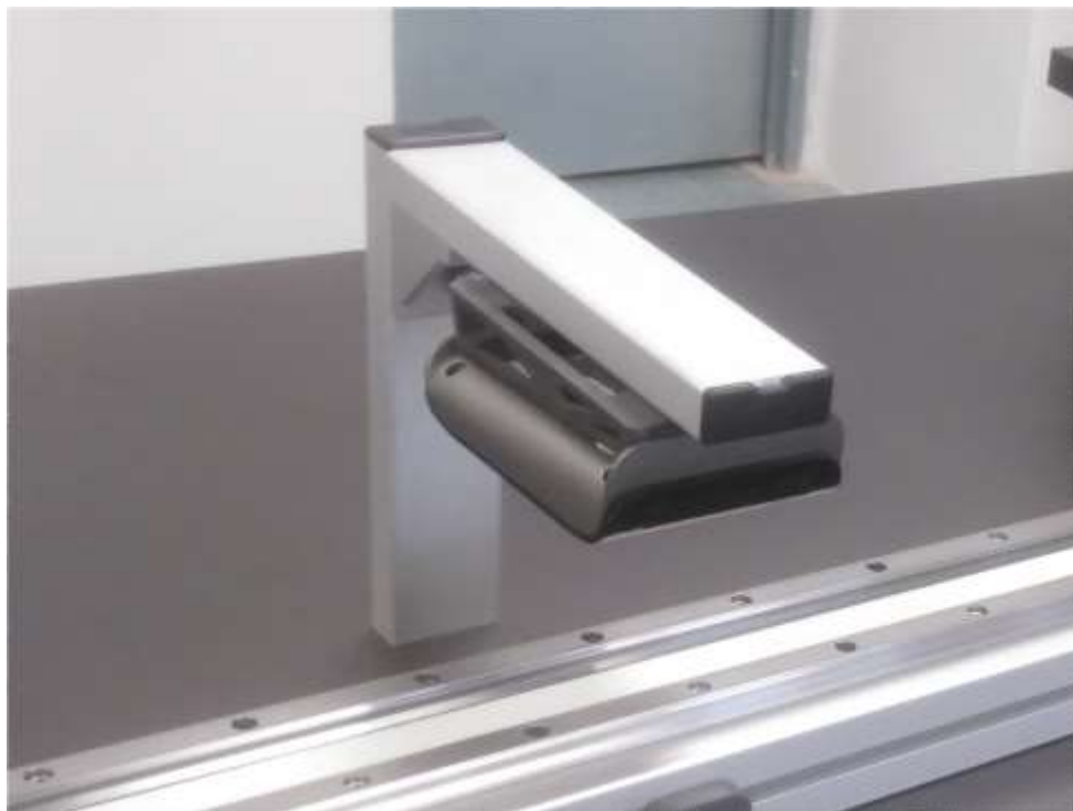
Lector RFID situado entre las diferentes etapas de la Línea 1 de la PFI
