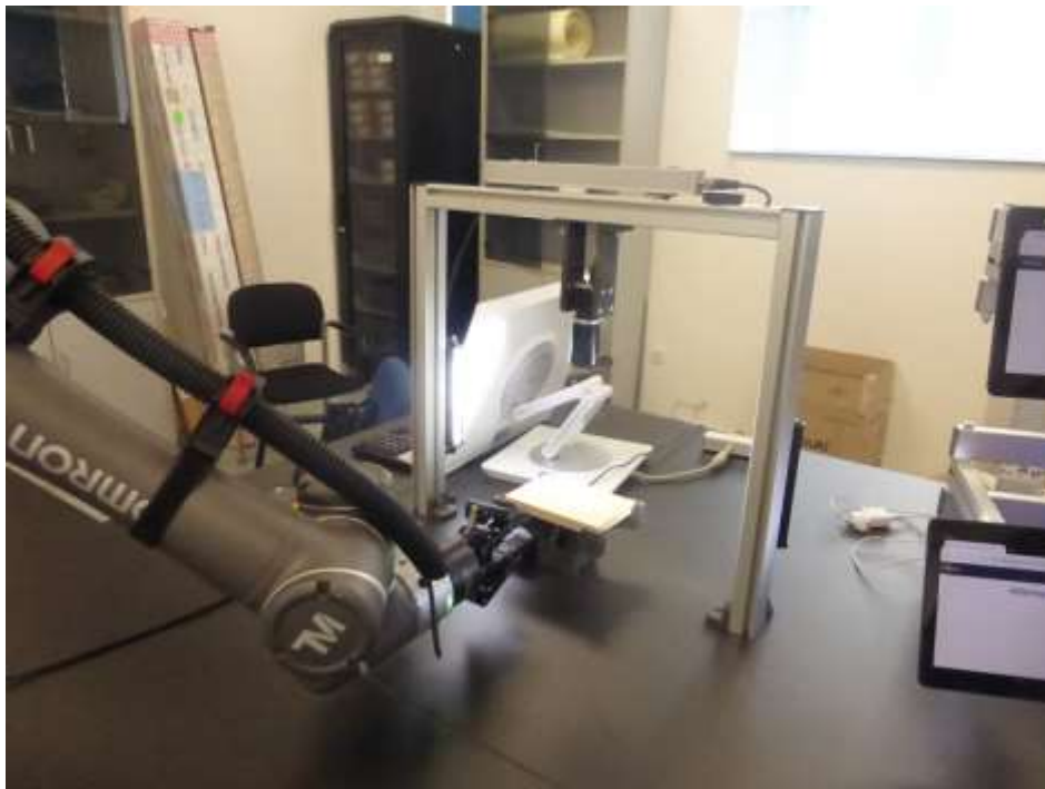
Figura 7- Inserción en la cuna de control de calidad
